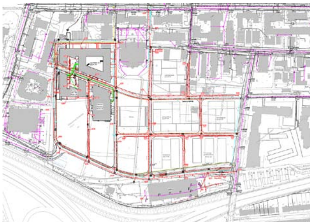
(Verlegeplan Ver- und Entsorgungsleitungen (gesamt))
